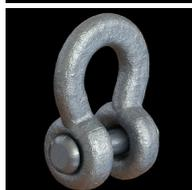
Eslabón en U (grillete) fabricado por proceso de fundición nodular con cuerpo en 5/8" de diámetro ensamblado con pasador en acero de 5/8" de diámetro y pin de seguridad, basada en norma NTC 2995 galvanizado en caliente.
