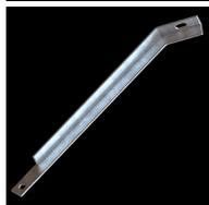
Diagonal recta con doblez, de 0,6 m (opcional de 0,64 m y 0,68 m) distancia entre centros de perforación, basada en norma NTC 2616 galvanizada en caliente, en el ancho y espesor de perfil en L de su preferencia.
