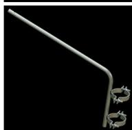
Soporte brazo para luminaria de 2,4 m de desarrollo, en la inclinación deseada en uno o dos dobleces con 2 collarines soldados al tramo cercano al poste. En el diámetro y espesor de tubo según la preferencia, galvanizado en caliente.
