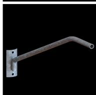
Soporte brazo sencillo para luminaria con platina curva soldada al tubo de 1500 mm basado en norma EDEQ. Se puede sujetar al poste por medio de 2 pernos o 2 collarines ensamblados a la platina. En el diámetro y espesor de tubo según la preferencia, galvanizado en caliente.
