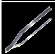
Bayoneta retención de 3 m basada en norma NTC 2616 galvanizada en caliente, en el ancho y espesor de perfil en L de su preferencia. Se realizan fabricaciones especiales con la cantidad y diámetro de perforaciones que se requieran.
