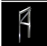
Bayoneta fin de línea de 1,499 m x 0,437 m compuesta por ángulos de 2 1 /2" x 1/4" galvanizado en caliente.
