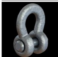
Eslabón en U (grillete) fabricado por proceso de fundición nodular con cuerpo en 3/4" de diámetro ensamblado con pasador en acero de 3/4" de diámetro y pin de seguridad, basada en norma NTC 2995 galvanizado en caliente.
