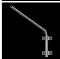
Soporte brazo de 1,8 m para luminaria de 1 o 2 dobleces con platinas soldadas para fijación a muros, en la inclinación deseada, en el diámetro y espesor de tubo según la preferencia, galvanizado en caliente.
