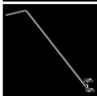
Soporte brazo largo de 2800 mm para luminaria fijación con abrazadera para poste de concreto. Basado en la norma Codensa ET832, en el diámetro y espesor de tubo según la preferencia, galvanizado en caliente.
